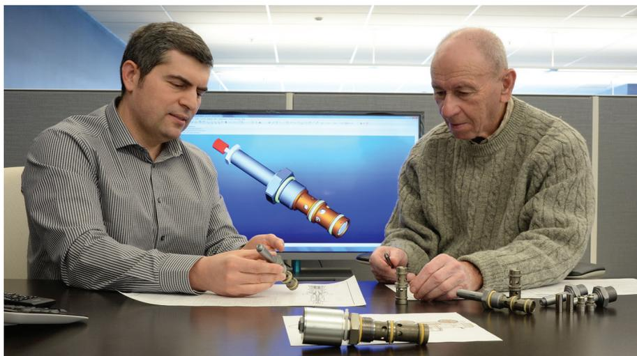
*Die HSPEC-Ventile vereinen eine Proportional-Steuerung mit einer Druckwaage, um Platz zu sparen und die Effizienz zu steigern.*
